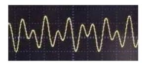
Das DTMF-Signal beinhaltet zwei NF-Frequenzen, die in der folgenden Tabelle aufgeführt sind, und die zu der oben gezeigten komplexen Wellenform führt.
